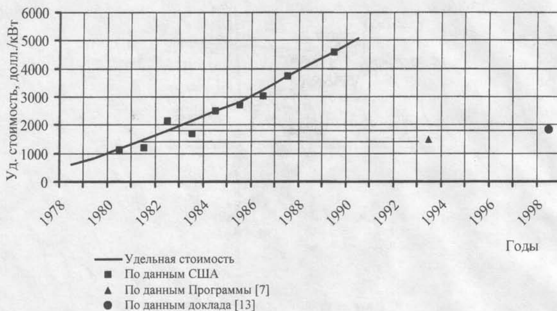
Рис.4 Удельная стоимость строительства реакторов
